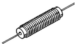
Fig. 17 - Tipo di impedenza per A.F. autorisonante. È avvolta su di un supporto in ceramica, ed il valore C necessario per la risonanza è dato dalla capacità distribuita.
