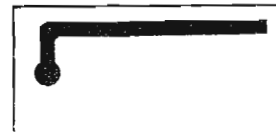
Fig. 6-B - A disegno ultimato, le connessioni vengono annerite con inchiostro di china opaco, o con acquarello nero. E' bene evitare inchiostri lucidi, che possono provocare riflessi dannosi nella ripresa fotografica.
