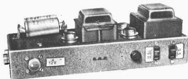
Fig. 9 - Fotografia dell'apparecchio, interamente montato, visto posteriormente. Si osservi anche qui la disposizione delle prese installate sul lato verticale posteriore. A lato degli attacchi di uscita è riportato il valore dell'impedenza del carico (altoparlante).
