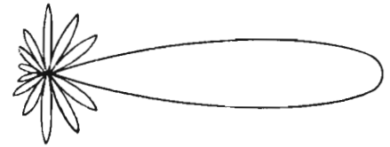
Fig. 16 - Diagramma illustrante la direttività di una antenna rombica non risonante (monodirezionale).
