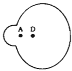
Fig. 5-B - Diagramma di irradiazione della antenna del tipo di figura 5-A.
