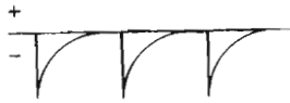
Fig. 4 - Impulsi negativi applicati all'ingresso del multivibratore. Le caratteristiche di funzionamento sono tali che detti impulsi vengono trasformati in onde rettangolari.
