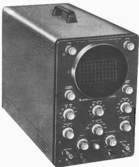
Aspetto dell'oscillografo modello OM-3 interamente montato. I comandi sono distribuiti razionalmente sul pannello, per un comodo impiego. L'involucro è una cassetta metallica verniciata a fuoco.
