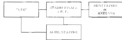
Fig. 5 - Schema a blocchi del trasmettitore perfezionato. Come si nota, esso consta di tre sezioni separate: le prime due («V.F.O.» e stadio finale), sono alimentate dalla medesima sorgente. La terza consta semplicemente di una bobina e di un commutatore.
