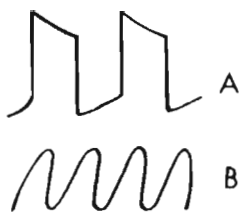
Fig. 10 - In A, segnale risultante con reazione eccessiva: in B, invece, la tensione di reazione è molto inferiore.
