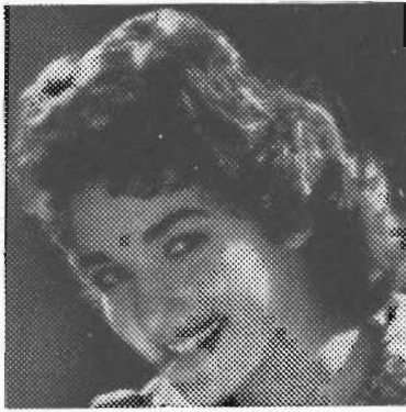
Fig. 11 - Frammento di «cliché» (ottenuto con la macchina di fig. 10), ingrandito per mettere in evidenza il «retino». A lato è rappresentata la puntina di incisione in acciaio.
