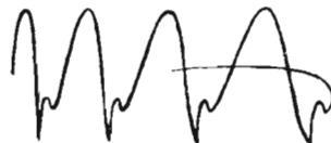
Fig. 15B - Se il valore di R viene ridotto a zero, ossia in assenza completa di controreazione, il segnale prodotto risulta notevolmente distorto.
