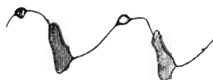
Fig. 1 — Presenza di oscillazioni ad Alta Frequenza, in un segnale di Bassa Frequenza.
