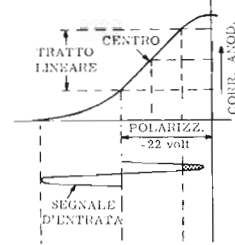
Fig. 16 - B - Funzionamento in classe AB1: la polarizzazione, e la potenza ottenibile, hanno valori medi.
