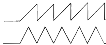
Fig. 2-B - Forme d'onda a dente di sega, in alto, e triangolare, in basso.
