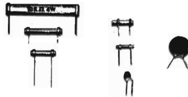
Fig. 14 - Componenti cilindrici ed a pastiglia, a terminali radiali, di comune impiego sui circuiti stampati.
